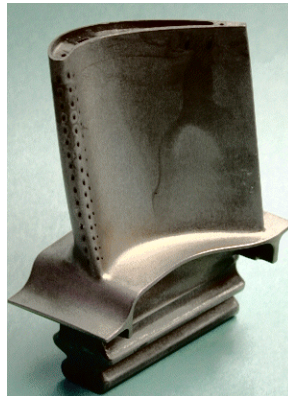
Figure 6: Aube de turbine monocristalline, avant application du revêtement protecteur (sous-couche et couche de zircon) (d'après un document Snecma Moteurs).
