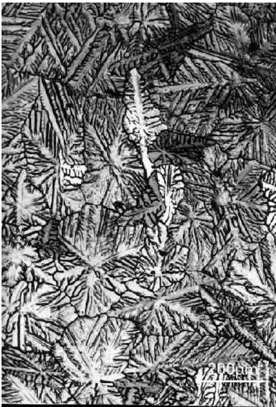
a. Microstructure d'un revêtement de tôle d'acier galvanisée.
