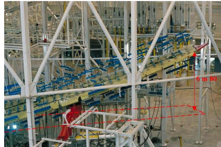
Fig 2. Test de flexion d'aile (Doc. Airbus)
