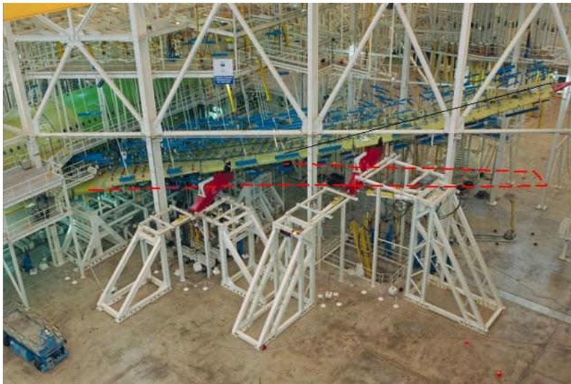
Fig 2. Test de flexion d'aile (Doc. Airbus)
