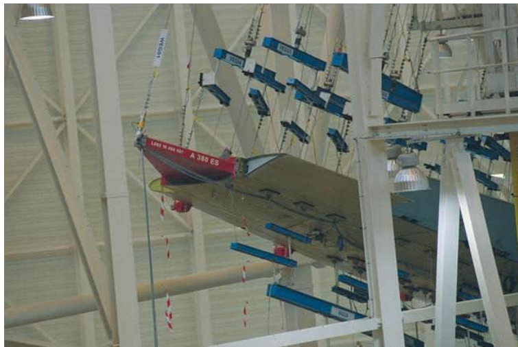
Fig 3. Vue du système de fixation en bout d'aile (Doc. Airbus)
