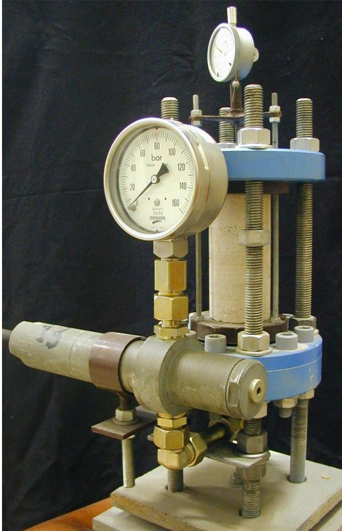
Fig.1 : Dispositif expérimental pour un essai de compression uniaxiale
